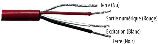
Figure 2 : Fils du câble pigtail
